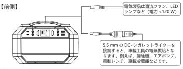
※ 本機の DC 直流出力電圧の範囲は 9 V~12.6 V で、最大出力電流は 12 A です。電池が化学品であるため、DC DC 電圧は電池容量の低下とともに低下します。もし接続されたDC 12 V の電気製品に充電安定機能が付いていないと、入力電圧が低すぎて光機が点灯します。接続を切断し、本機の充電を行ってください。
