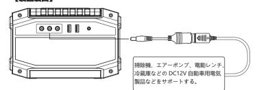
※ 電池は化学製品で電圧随容量が落ちて下がる。接続する DC12V 機器が電圧レギュレータ機能を持たない場合、本製品の DC 端子電圧が内蔵電池電圧で低下すると、 DC12V 機器の電圧が低下する可能性があります。電気器具を使用停止状態にするには、この機器の使用を中止してください。
